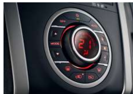
Régulation automatique de la climatisation.
